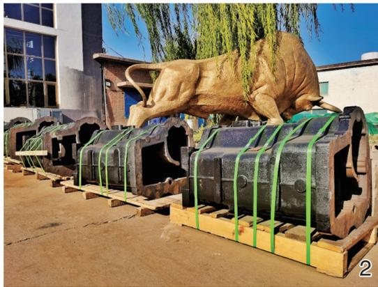
打印铸造省内外市场,除发动机壳体外,近期已成功研发出不锈钢叶轮、陶瓷衬板等中高端零部件新产品,促进酒钢装备制造产业不断提质增效、转型升级。图1为职工正在操作3D打印设备,图2为3D打印法特发动机壳体。
