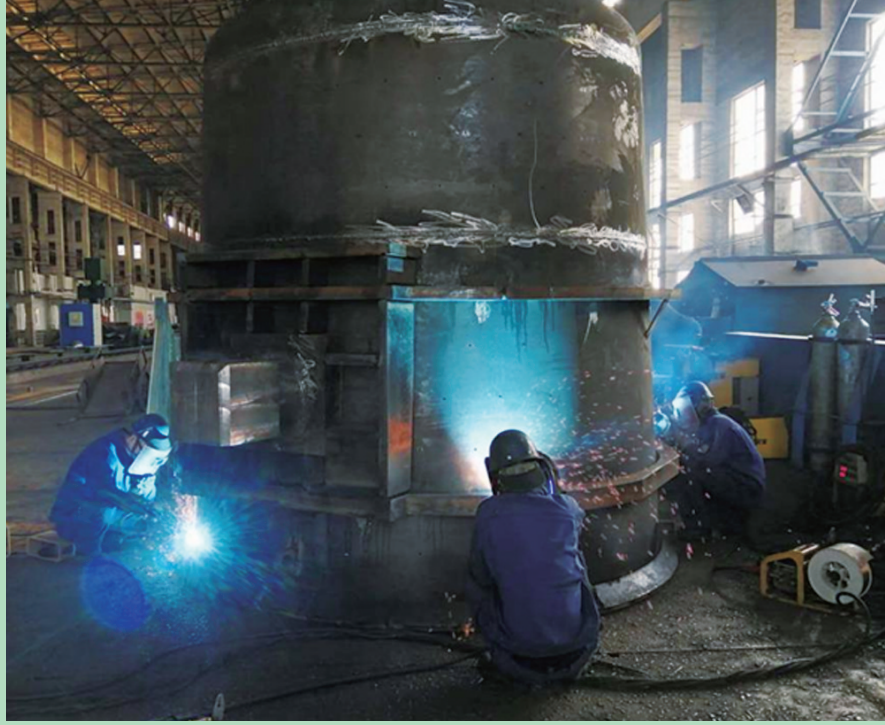
参观柳焊车间工人焊接钢包
