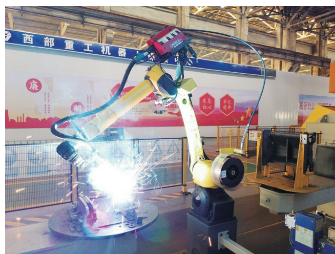
西部重工公司铆焊分厂积极发挥焊接机器人焊接效率高、焊接变形小等优势,利用龙门式焊接机器人焊接矿车车厢侧门和车厢立柱、横梁等,利用小机器人焊接链斗、车厢托托以及铸铁链板等产品,保证了产品交货工期。周永虎 摄
