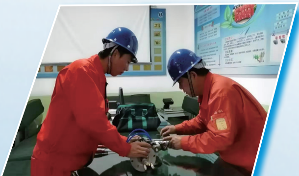
检修工程部职工组装高炉料罐压力自动清堵取压装置。于娟丽 摄
