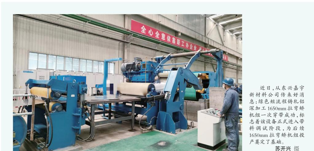
近日,从东兴嘉宇新材料公司传来好消息:绿色短流程铸铝深加工1650mm拉弯矫机组一次穿带成功,标志着该设备正式进入带料调试阶段,为后续1650mm拉弯矫机组投产奠定了基础。
