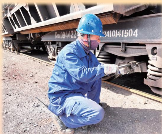
烈日炎炎,火辣辣的太阳将热量肆意洒向宏兴股份运输部嘉北站场作业现场的每一寸角落。检车员穿行在如同“烤箱”的车列中,汗水在满是灰尘的脸上留下一条条清晰的痕迹,他们顶着烈日暴晒和热浪侵袭,战高温、迎“烤”验,没有丝毫懈怠,对车辆走行、制动、车体、钩缓等进行细致排查,每名检车员平均每班要步行15公里,重复上千次弯腰的动作。6月份,嘉北站场共整备K16矿石车10412辆,消除14项车辆故障隐患,更换2972块闸瓦,平均每天完成技检347辆。
