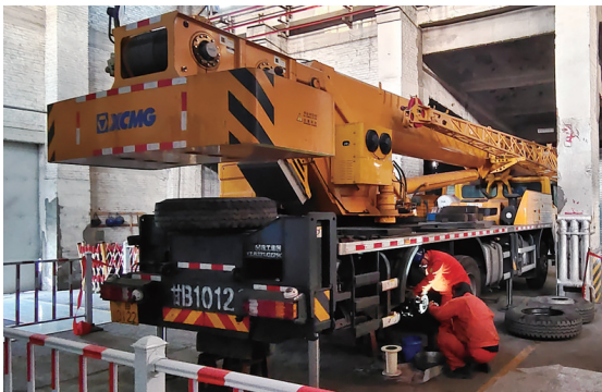
近期,宏兴股份检修工程部开展车辆运输安全专项排查,全面排查车辆制动、润滑油、轮胎磨损等影响安全的问题,为保障夏季车辆安全稳定运行奠定了基础。高小刚 摄
