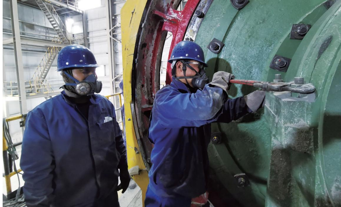
近日，润源公司冶金渣处理作业区开展全流程选线全停检修工作，主要对除尘管道和2号破碎机进料检修，对棒磨车间给料机和7号皮带进行更换。检修期间，该作业区管理技术人员全程跟踪盯控检修作业，及时协调解决各项难题，检修工作如期圆满完成。
