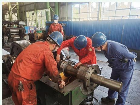
近日,宏兴股份检修工程部炼轧检修作业区大棒检修室检修人员开展齿轮箱修复装配工作,大家分工明确、密切配合,熟练地进行齿轮箱零件安装及间隙测量,为设备安全运行保驾护航。
