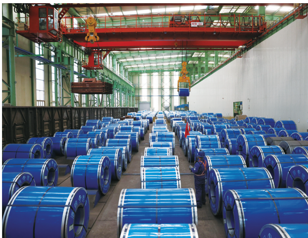
随着宏兴股份碳钢板厂酸镀锌投产,与该产线相配套的产品外发库房也在近日全面投用。新库房位于酸镀锌厂房东侧,长160米,宽27.5米,占地面积4400平方米,配备492个货位,设计日产品外发量32车1800吨。截至目前,该库房已累计外发产品71007.5吨。张瑾 摄
