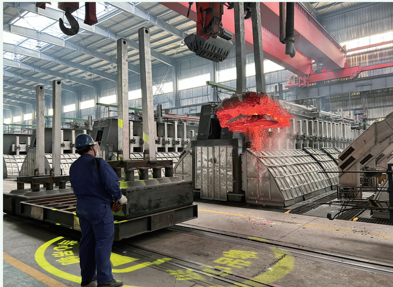
进入四季度,东兴铝业公司电解四作业区精准对标分析,进一步提高电解生产、现场管理、电解槽换极等工作标准,全面提升电解工艺管控和操作水平,促进指标再提升。图为职工进行电解槽换极作业。张静 摄
