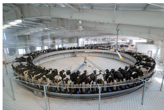
祁牧乳业公司全自动80位转盘式挤奶设备。
