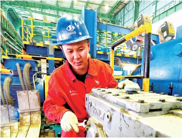
宏兴股份检修工程部职工紧固设备边盖螺栓。
