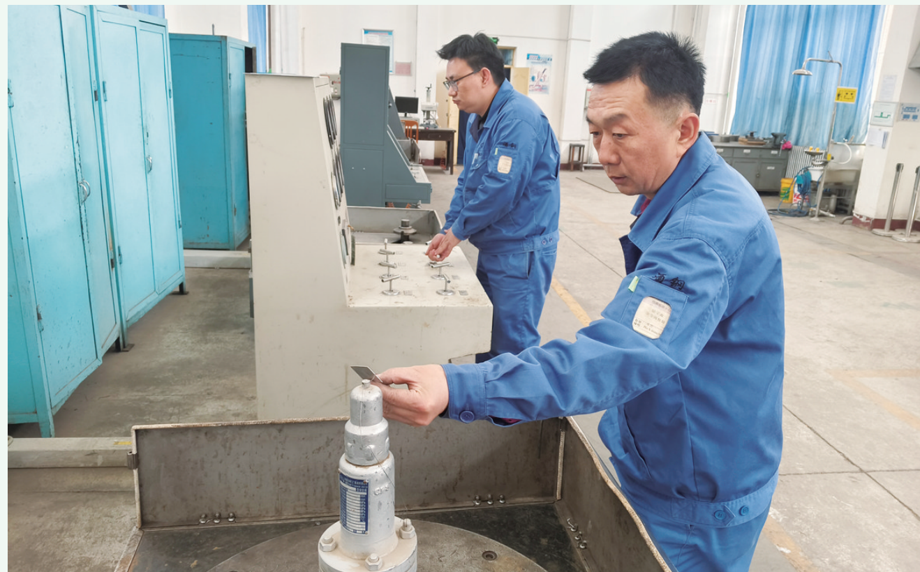
近日,检验检测中心特种设备检测站将近几年来在安全阀校验工作中所发现的问题,精心整理成检验案例,通过以“案”说“阀”的方式,有效指导企业安全用阀。图为安全阀作业人员调整整定压力。 席军峰 摄
