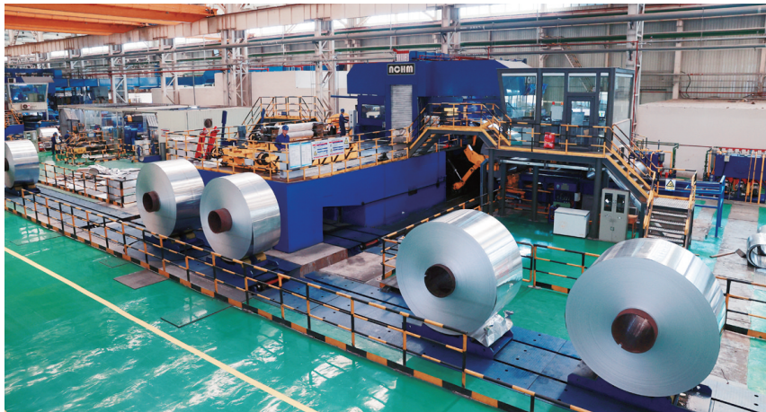
图为新投产的冷精轧机。 张志方 摄
